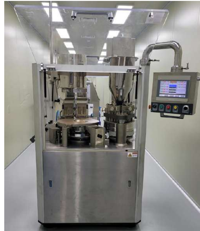
ハードカプセル充填装置(650,000 Cap/ 8H #2)
